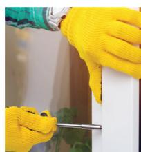
Damit sich ein Fenster «RC2-geprüft» nennen darf, muss es in einem Härtetest einiges über sich ergehen lassen.
